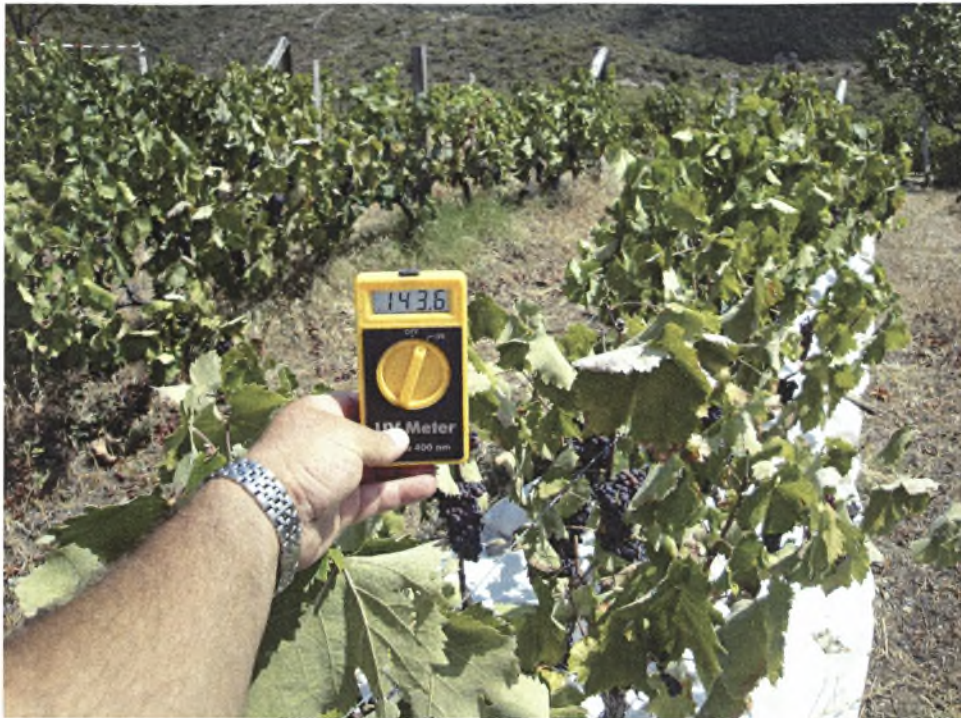
Εικόνα 3.6: Μέτρηση ηλιακής ακτινοβολίας με φορητό μετρητή ΦΑΕ (μοντέλο LQS-QM, Spectrum Technologies Inc)
