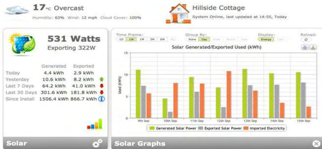
Εικόνα 2. Σύστημα παρακολούθησης και έλεγχου της ηλεκτρικής ενέργειας.
