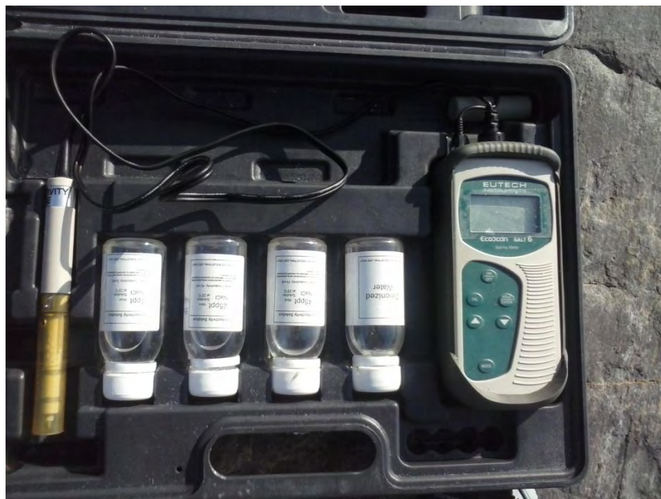
Εικόνα 2.2 Αλατόμετρο για την καταγραφή θερμοκρασίας και αλατότητας.
