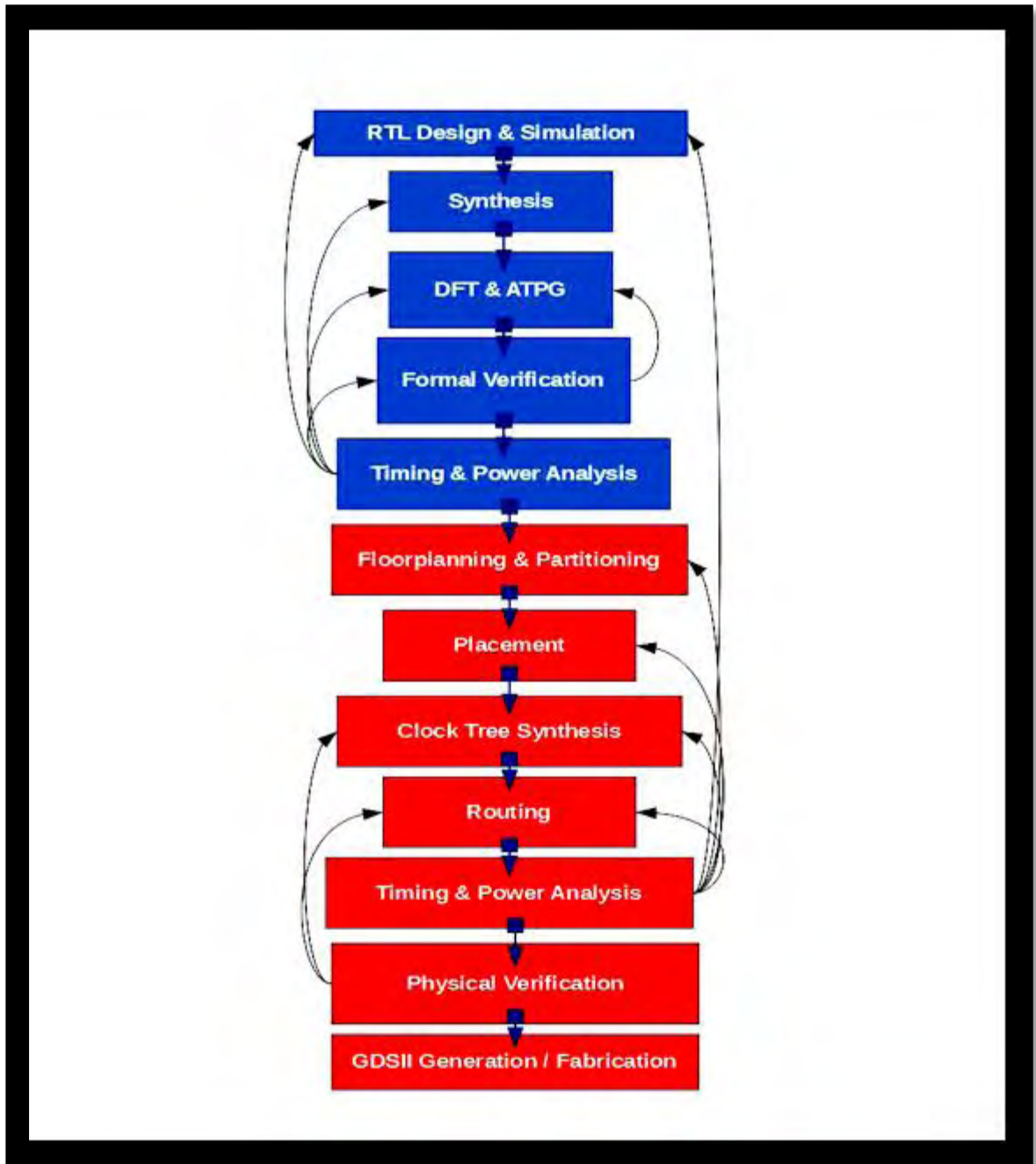
Εικόνα 6 Simplified ASIC Design Flow. Με μπλε χρώμα απεικονίζεται η front-end σχεδίαση και με κόκκινο η back-end σχεδίαση
