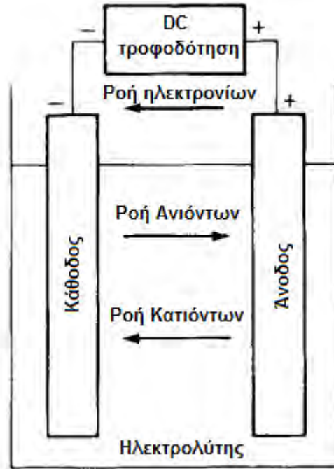
Σχήμα 4.2: Απλή απεικόνιση της διαδικασίας φόρτισης ενός (επαναφορτιζόμενου) στοιχείου
