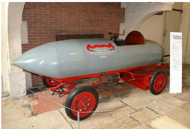
Εικόνα 3.1: La Jamais Contente ήταν το πρώτο όχημα που κατάφερε να επιτύχει ταχύτητα μεγαλύτερη των 100 Km/h. Ήταν ηλεκτρικό και το ρεκόρ επετεύχθη μεταξύ 29 Απριλίου με 1 Μαΐου του 1899. Το αμάξιωμα ήταν κατασκευασμένο από κράμα αλουμινίου, βολφραμίου και μαγνησίου.
