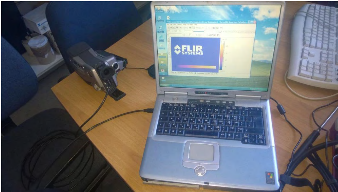
Εικόνα 55: Φωτογραφία του laptop που συνοδεύει την υπέρυθρη κάμερα και του τρόπου σύνδεσης με αυτήν.
