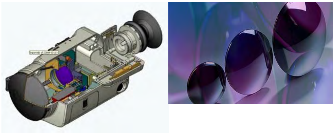
Εικόνα 24: Απεικόνιση του εσωτερικού μιας υπέρυθρης κάμερας (αριστερά)- φακοί κατασκευασμένοι από γερμάνιο (Ge) για χρήση σε υπέρυθρες κάμερες (δεξιά).
