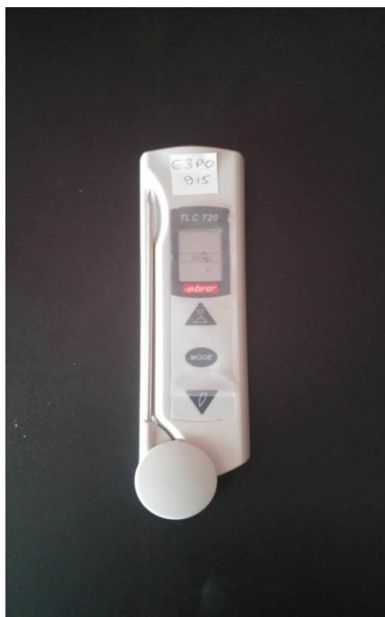
Εικόνα 1. Ειδική συσκευή υπέρυθρης καταμέτρησης θερμοκρασίας.
