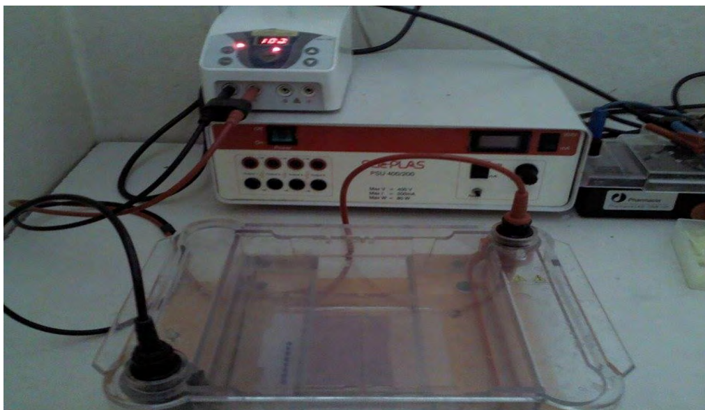
Εικόνα 8. Συσκευή οριζόντιας ηλεκτροφόρησης πηκτής αγαρόζης
