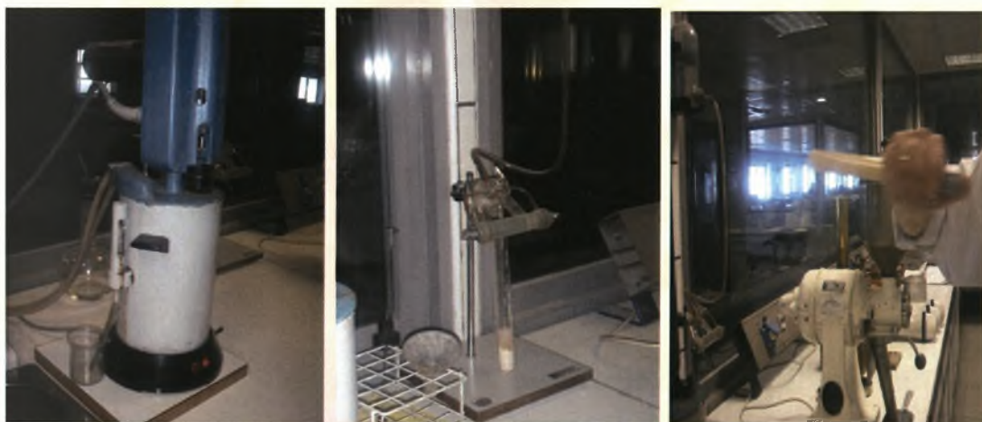
Εικ. 28. Προσδιορισμός του αριθμού πτώσης FN (Μύλοι Λούλη)
