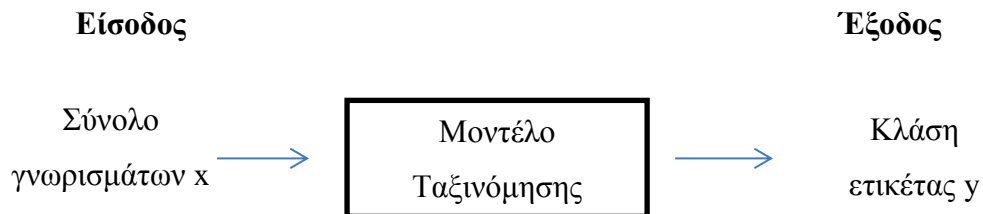
Σχήμα 2.1: Η ταξινόμηση ως διαδικασία αντιστοίχισης συνόλου γνωρισμάτων (x) σε κλάση ετικέτας y.
