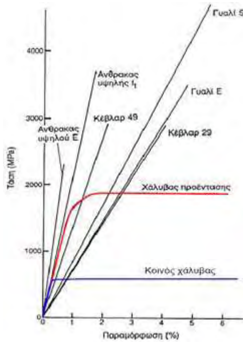
Σχήμα 5 ΤΥΠΙΚΕΣ ΚΑΜΠΥΛΕΣ ΤΑΣΗΣ – ΠΑΡΑΜΟΡΦΩΣΗΣ ΓΙΑ ΔΙΑΦΟΡΟΥΣ ΤΥΠΟΥΣ ΙΝΩΝ ΚΑΙ ΧΑΛΥΒΑ ΣΕ ΕΦΕΛΚΥΣΜΟ
