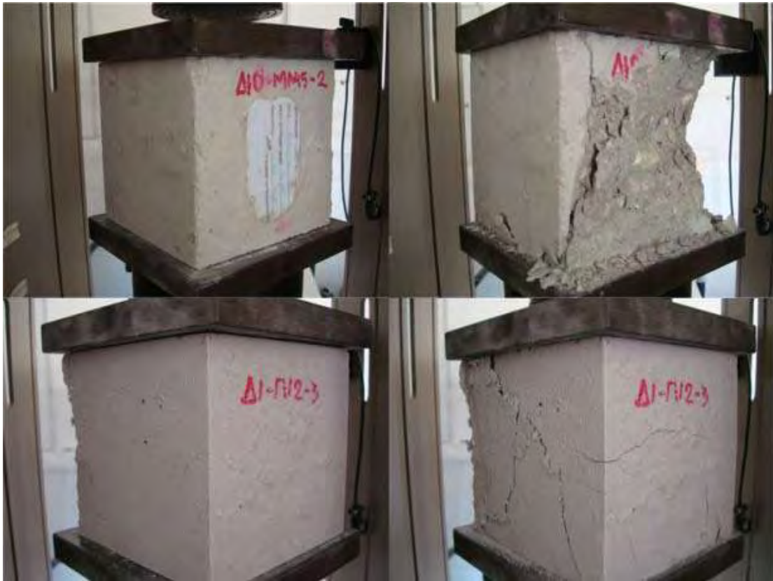
Σχήμα 25 ΤΡΟΠΟΙ ΑΣΤΟΧΙΑΣ: ΠΡΩΤΗ ΣΕΙΡΑ: ΠΛΕΥΡΙΚΗ ΑΠΟΛΕΠΙΣΗ ΔΟΚΙΜΙΩΝ. ΔΕΥΤΕΡΗ ΣΕΙΡΑ: ΠΛΕΥΡΙΚΗ ΔΙΟΓΚΩΣΗ ΔΟΚΙΜΙΩΝ
