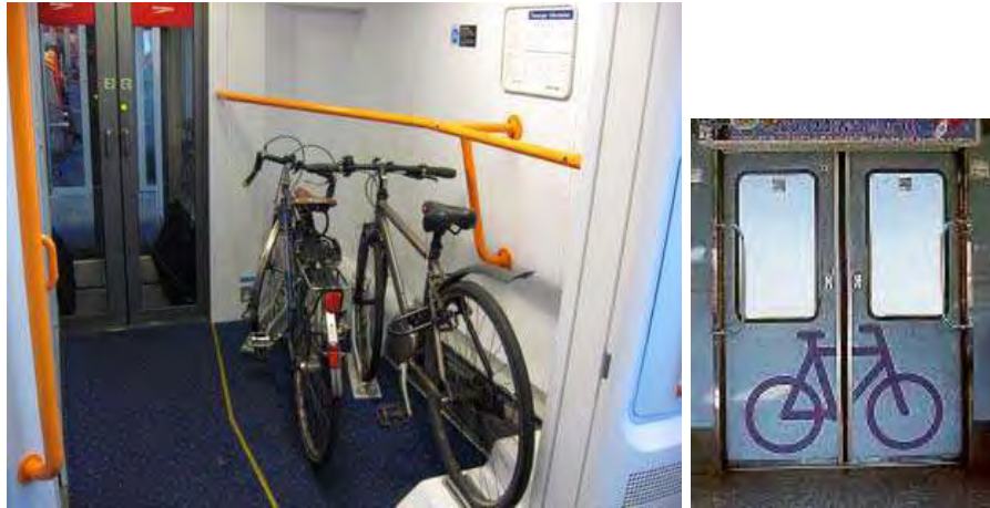
Εικόνα 2.8: Αγγλία. Ειδικός χώρος για την μεταφορά ποδηλάτου σε τρέινο
