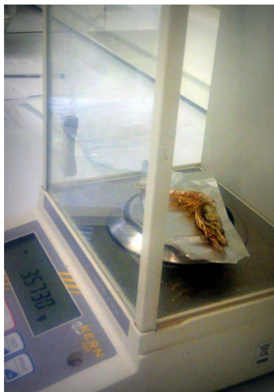
Εικόνα 3.5.: Μέτρηση βάρους σε ζυγό ακριβείας
