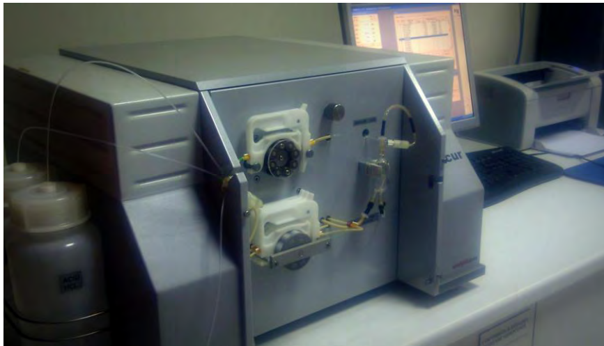
Εικόνα 3.14.: Φασματοφωτόμετρο Ατομικού Φθορισμού Ψυχρού ατμού (CV-AFS)
