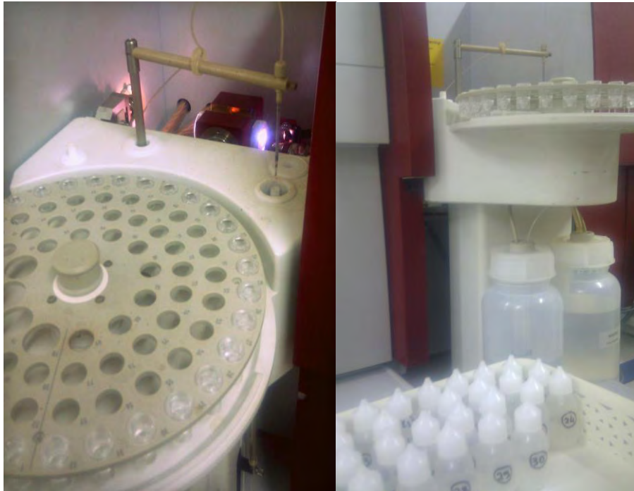
Εικόνα 3.12.: Ατομική απορρόφηση με φούρνο γραφίτη (Graphite Furnace AAS, GFAAS)
