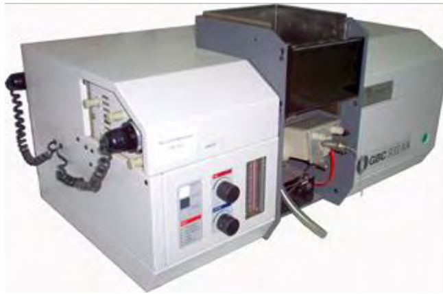
Εικόνα 3.11.: Ατομική Απορρόφηση με φλόγα (FAAS)
