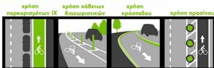
τύποι ασφαλή διαχωρισμού λωρίδων ποδηλάτου
