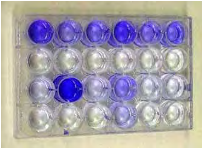
Εικόνα 14: (d) Το δεσμευμένο στη βιομεμβράνη κρυσταλλικό ιώδες εξήχθη προσθέτοντας στα πηγαδάκια 200 \mu l διαλύματος οξεϊκού οξέος και στη συνέχεια μετρήθηκε η απορρόφηση του (OD) στα 595 nm σε ένα αυτόματο φασματοφωτόμετρο.
