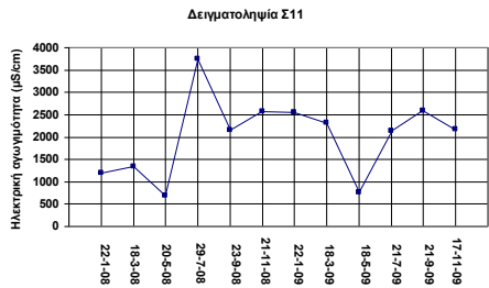
Σχήμα 9 : Η διακύμανση της ηλεκτρικής αγωγιμότητας (EC) σε μS/cm κατά τις 12 δειγματοληψίες.
