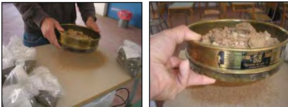
Εικόνα 16 : Κοσκίνισμα με κόσκινο βρογχίδας 2 mm 2
