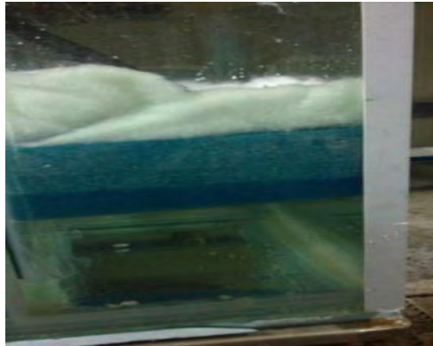
Εικόνα 9: Στάδιο μηχανικού φιλτραρίσματος (Πηγή: Προσωπικό αρχείο)
