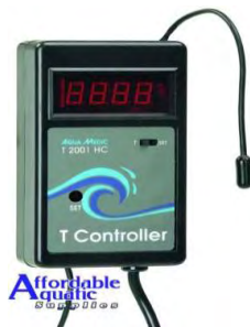
Εικόνα 13: Ρυθμιστής θερμοκρασίας T-controller (Πηγή: www.aqua-medic.de )
