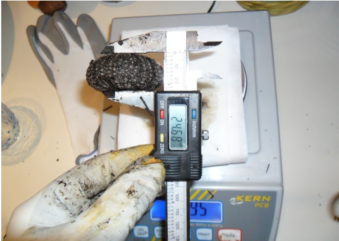
Εικόνα 11. Paracentrotus lividus . κατά την μέτρηση του ύψους του κελύφους. (φωτο: Παναγιώτης Ν. Μουρούτης)
