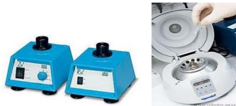
Εικόνα 21: Συσκευές ανάδευσης vortex και στροβιλισμού spin
