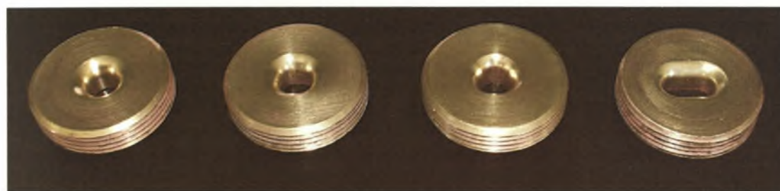
Σχήμα Β.3: Ακροφύσια από τη στρογγυλεμένη πλευρά εισόδου της φλέβας, διαμέτρων 1cm, τετραγωνικής, τριγωνικής και ορθογωνικής (από αριστερά προς τα δεξιά)
