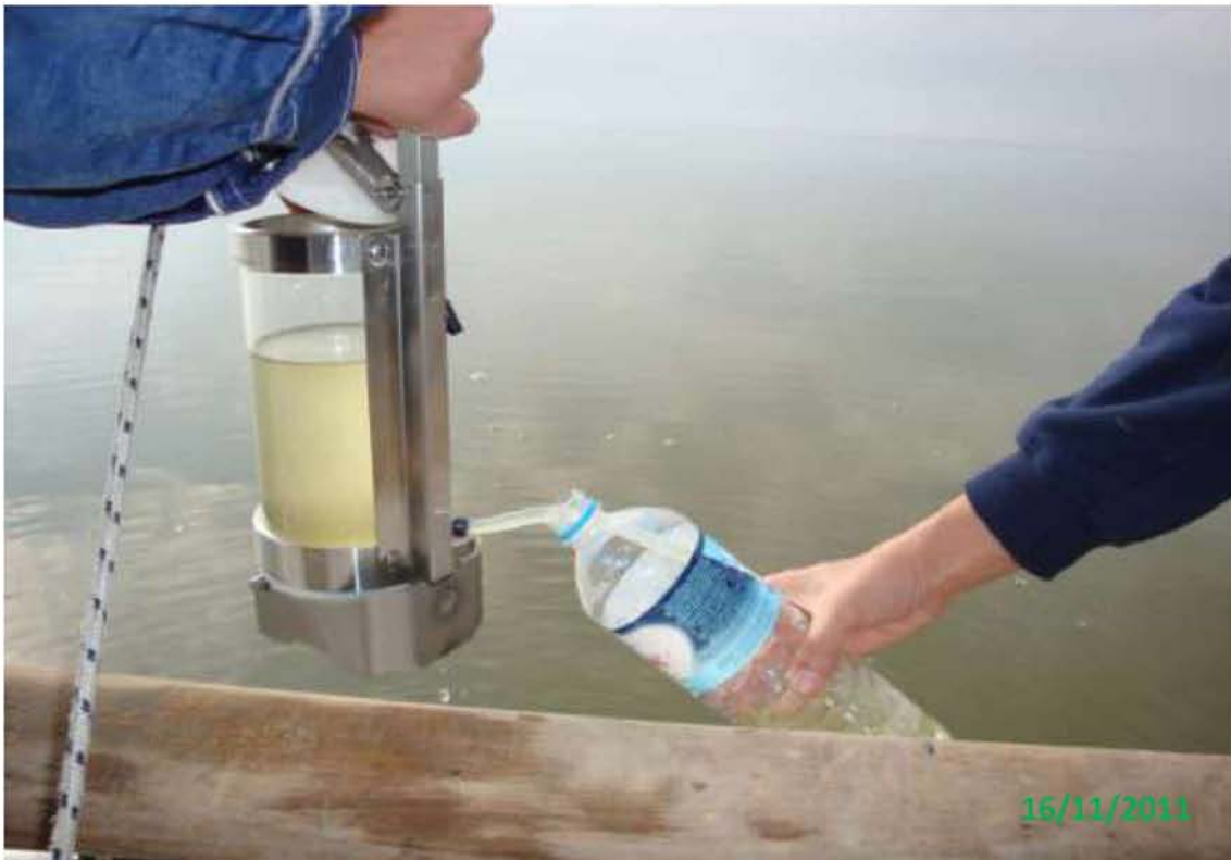
Εικόνα 2.2: Δειγματολήπτης νερού (Limnos Rossincatu 2 E 17 20380 Turku Finland)
