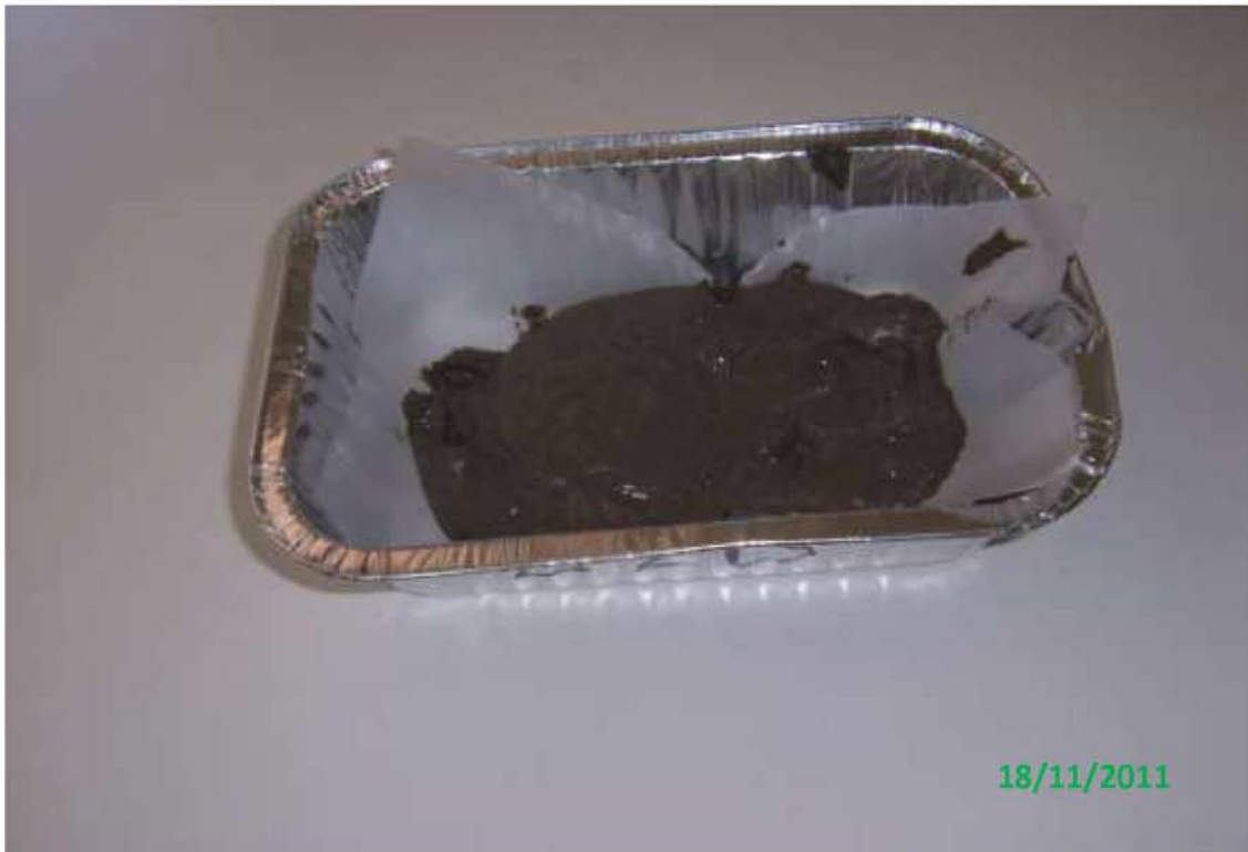
Εικόνα 2.8: Τοποθέτηση δειγμάτων ιζήματος σε ταψάκι αλουμινίου επενδυμένο με ριζόχαρτο.
