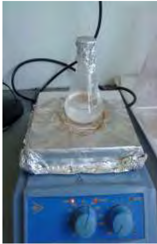
Εικόνα 18 : Μηχάνημα βρασμού και η κωνική φιάλη
