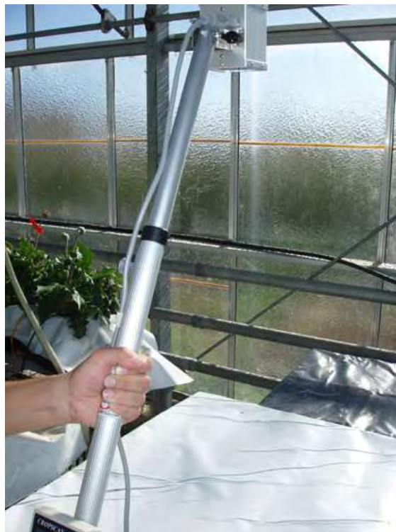
Εικόνα 48 Μετρήσεις ανάκλασης πάνω από λευκή επιφάνεια αναφοράς
