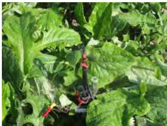
Εικόνα 47 Συνεχής διαβροχή για τη μέτρηση της T min (αριστερά) και κάλυψη με βαζελίνη – εμπόδιση διαπνοής για τη μέτρηση της T max (δεξιά)
