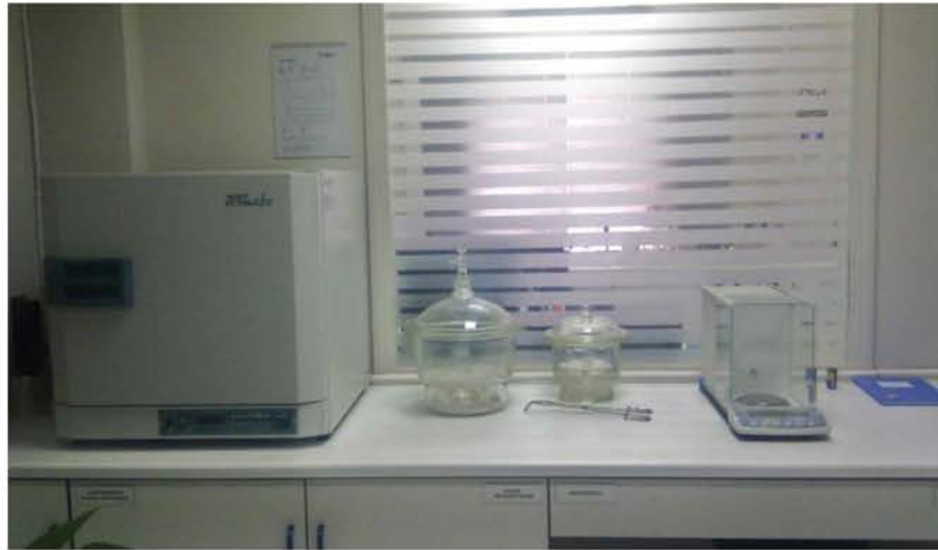
Εικόνα 2.7: Μέτρηση TDS μετά από διήθηση, εξάτμιση και ξήρανση
