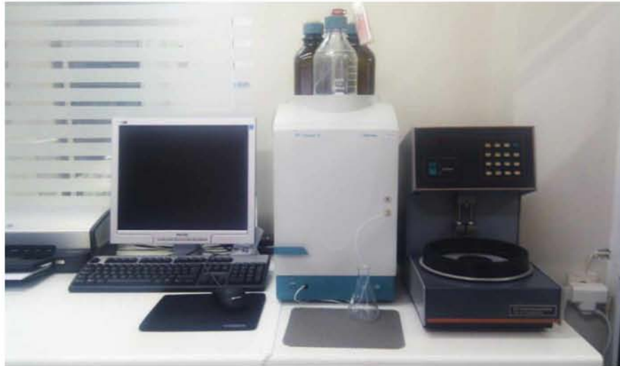
Εικόνα 2.5.: Ιοντική χρωματογραφία IC 761 του οίκου Metrhom και αυτόματος τροφοδότης δειγμάτων Autosampler 728 της Micrometrics.
