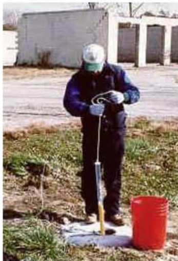
Εικόνα 2.2.: Λήψη δείγματος από γεώτρηση με δειγματολήπτη bailer sampler. http://www.epa.state.il.us/land/lust/introduction.html
