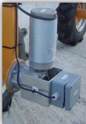
Τοποθέτηση αισθητήρα παλμών για μέτρηση ταχύτητας
