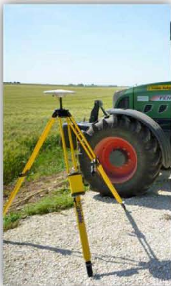
Σταθμός βάσης σε σύστημα RTK GPS
