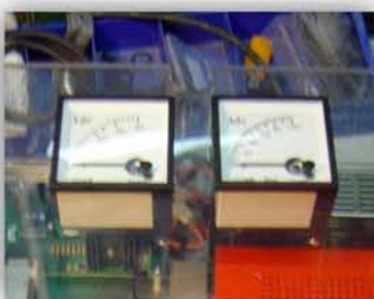
Όργανα μέτρησης τάσης και ρεύματος τροφοδοσίας
