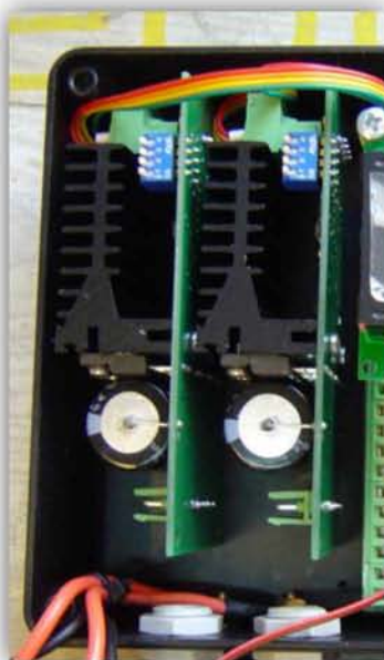
Τοποθέτηση κυκλωμάτων οδήγησης στο κουτί ηλεκτρονικών σε κάθε πόδι
