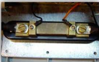
Αντίσταση για μέτρηση ρεύματος τροφοδοσίας
