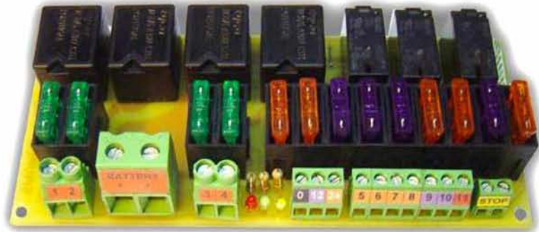
Εικόνα 3.5 : Power Distribution Board
