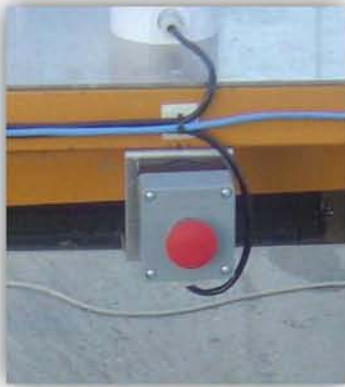
Μπουτόν έκτακτης διακοπής τροφοδοσίας στο μπροστινό μέρος του οχήματος
