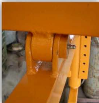
Το όχημα διαθέτει δύο σημεία περιστροφής στον διαμήκη άξονα
