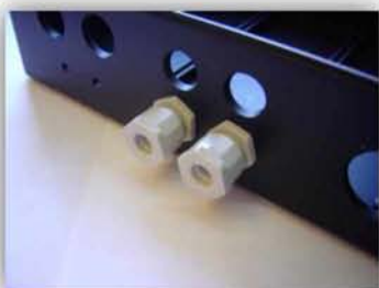
Οπές στο κουτί ηλεκτρονικών LegBoard για την είσοδο των καλωδίων
