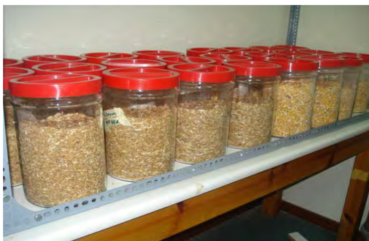
Φωτ.2: Γυάλινα δοχεία με σιτάρι και καλαμπόκι ψεκασμένα σε 3 επίπεδα συγκέντρωσης και 1 μάρτυρα
