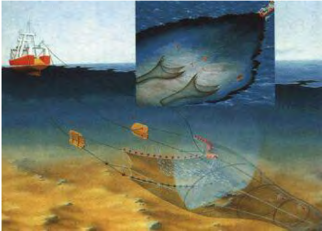
Εικόνα 2.4 Τρόπος αλίευσης με μηχανότρατα από το βυθό.
