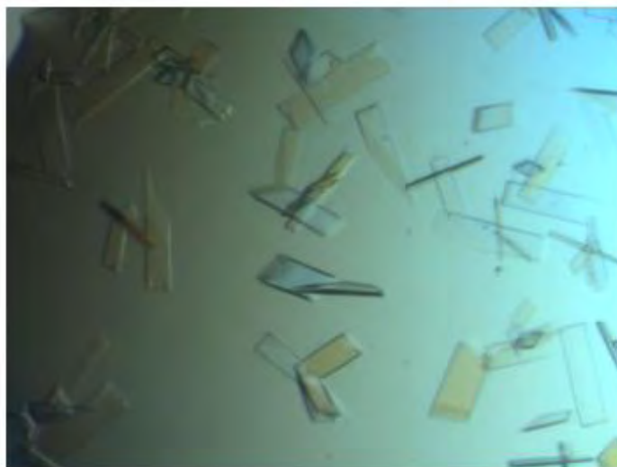
Εικόνα 37. Παρακολούθηση κρυστάλλων με στερεοσκόπιο Leica MZ16, 160X, εφοδιασμένο με σύστημα πολωμένου φωτός και φωτογράφιση με ψηφιακή κάμερα. Κρυστάλλωση 4,6mg/ml οξειδάσης της ξανθίνης με αλλοπουρινόλη σε συνθήκες κατακρημνιστικού παράγοντα: 0.1 M Na HEPES pH 7.5, 10 % w/v PEG 6000, 5% v/v MPD.
