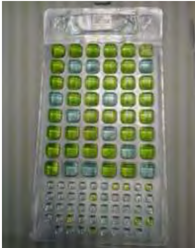
Εικόνα 7: Δείγμα νερού μέσα σε σακούλα Quanti-tray/2000s μετά από επώαση και με θετικά πηγαδάκια.
