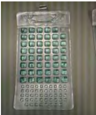
Εικόνα 5: Δείγμα νερού μέσα σε σακούλα Quanti-tray/2000s πριν από την επώαση.
