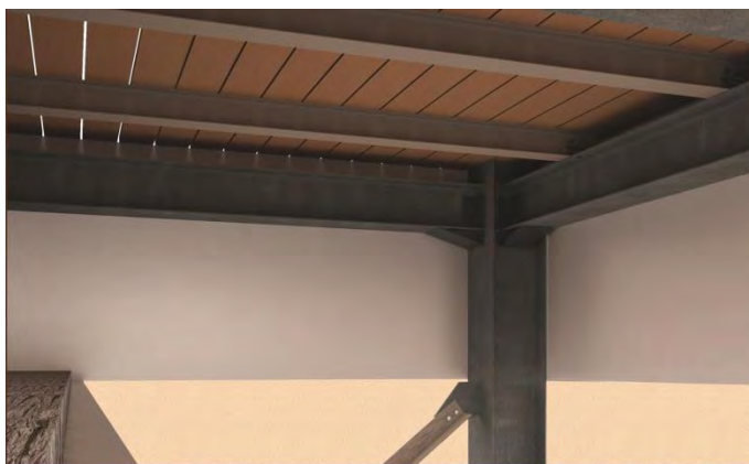
Λ1: Σύνδεση υποστήλωματος HEB 320 με δοκό HEA 240, δοκούς IPE 120 και αντιανέμια L100x100x10
