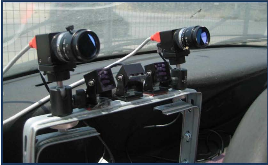
Εικόνα 6.9: Κάμερες καταγραφής της κίνησης του βλέματος του οδηγού και της θέσης του κεφαλιού
