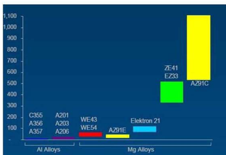
Σχήμα 3.4: Ρυθμοί διάβρωσης κράματος Mg και Al σε δοκιμασία αλατονέφωσης [61]
