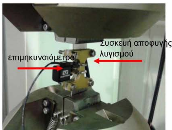
Σχήμα 5.3: Πειραματική διάταξη δοκιμής ολιγοκυκλικής κόπωσης
