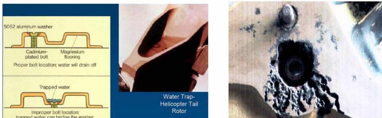
Σχήμα 3.9: Διάβρωση λόγω σχεδιασμού
