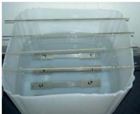
Σχήμα 4.1: Εμβάπτιση δοκιμίων σε NaCl 3,5%
