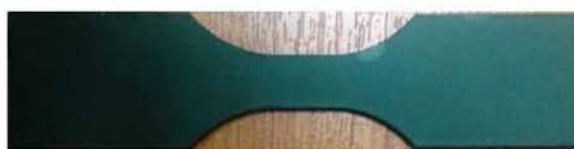
Σχήμα 4.10: Δοκίμιο με επικάλυψη
