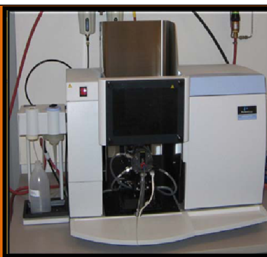
Εικόνα 2.5. Φασματοφωτόμετρο ατομικής απορρόφησης του οίκου Perkin Elmer AAnalyst 400 με φλόγα αέρα ακετυλενίου http://las.perkinelmer.com/
