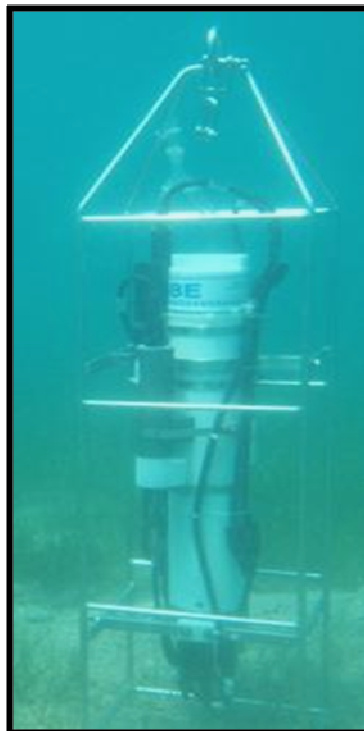
Εικόνα 2.2. Αυτογραφικό όργανο CTD
