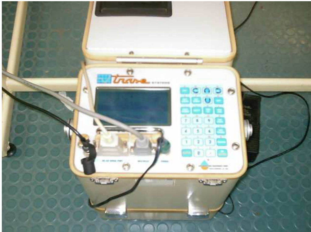
Εικόνα 2.1 Η Συσκευή TDR
