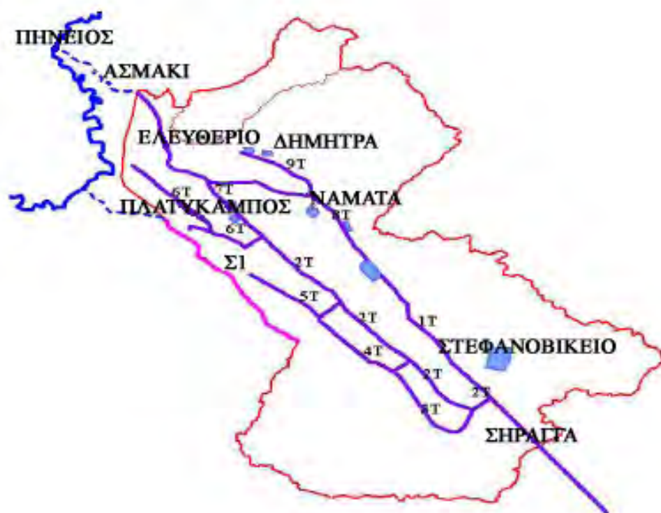
Σχήμα 3.5: Τα πρώτα αποστραγγιστικά έργα στη λεκάνη απορροής της Κάρλας (Φώλια 2008)
