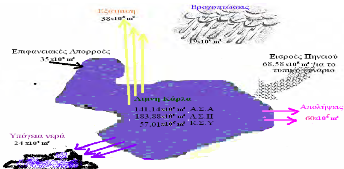
Σχήμα 3.24: Υδάτινο ισοζύγιο λίμνης Κάρλας (Μέσες υδρολογικές συνθήκες )
