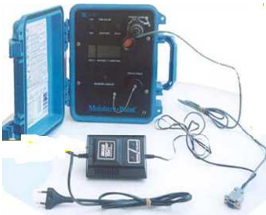
Εικόνα 15. Συσκευή T.D.R. μαζί με τα μέρη που την αποτελούν.
