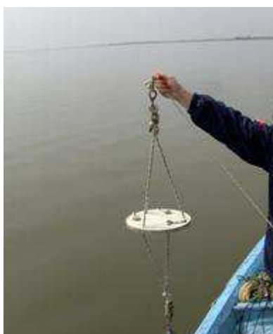
Εικόνα 21. Μέτρηση φυσικών παραμέτρων νερού(διαφάνειας), με δίσκο του SECCHI.(Φωτ. Ντερεμίδης Χ.)
