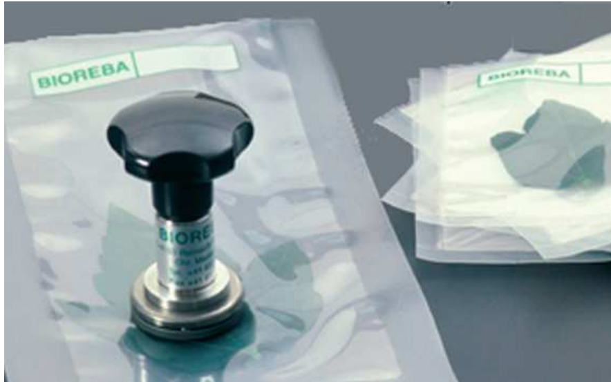
Εικόνα 2.2.1. Ομογενοποιητής χειρός και σακουλάκια τύπου ELISA (BIOREBA) που χρησιμοποιήθηκαν στην ομογενοποίηση του φυτικού ιστού κατά την απομόνωση του DNA βάσει του πρωτοκόλλου Maixner (Πηγή: http://www.bioreba.ch/?idpage=2&CatID=2&ProduktID=114.01 ).
