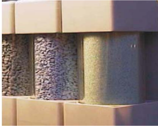
Σχήμα 4.9. Φυσίγγια χημικών για ρύθμιση συγκέντρωσης του H 2 O στον θάλαμο του φύλλου
