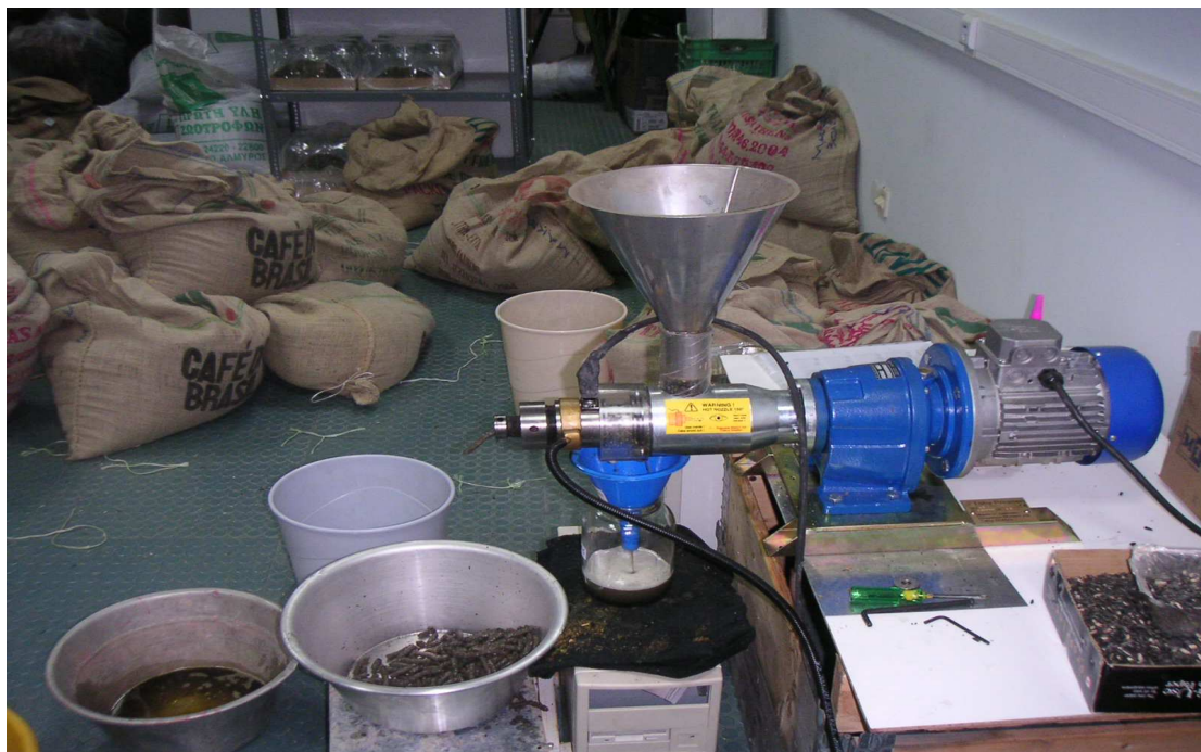
Εικόνα 7. Μηχανή ψυχρής συμπίεσης του σπόρου με κοχλία
