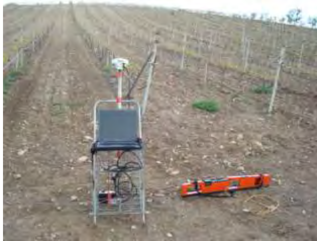
Σχήμα 3.9. Αισθητήρας ηλεκτρομαγνητικής επαγωγής EM 38 συνδεδεμένος με δέκτη GPS μέσω φορητού ηλεκτρονικού υπολογιστή
