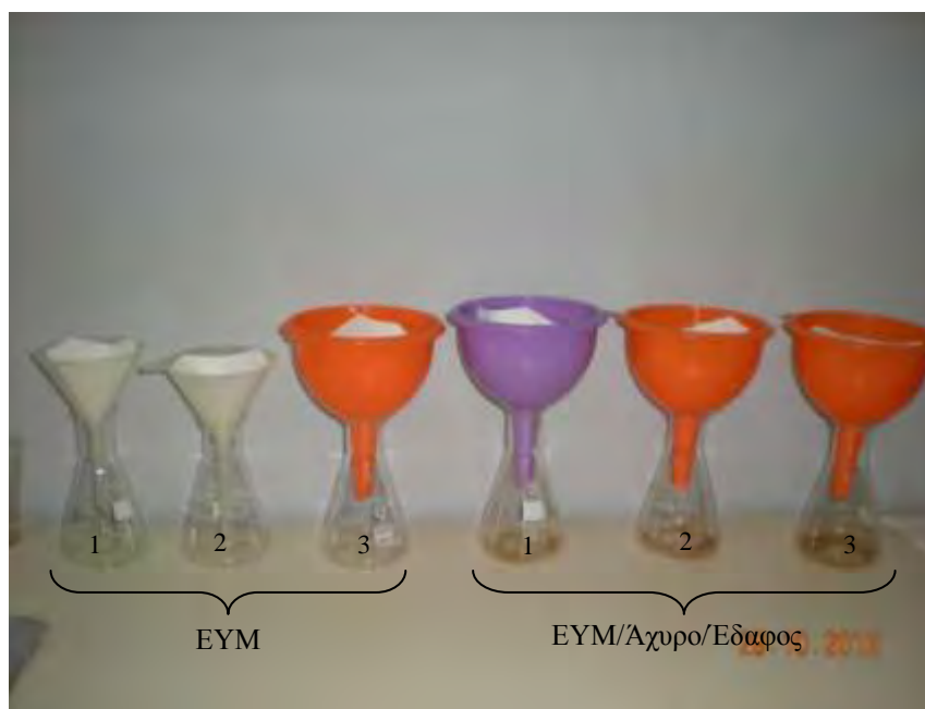
Εικόνα 2.3. Προσδιορισμός υδατοχωρητικότητας των υποστρωμάτων
