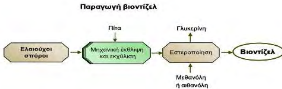
Σχήμα 3. Διαδικασία παραγωγής βιοντίζελ
