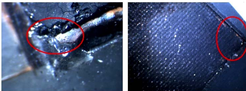
Σχήμα 9.19: Παρατήρηση στο ηλεκτρονικό μικροσκόπιο της διάταξης μεμβράνης–ηλεκτροδίων.
