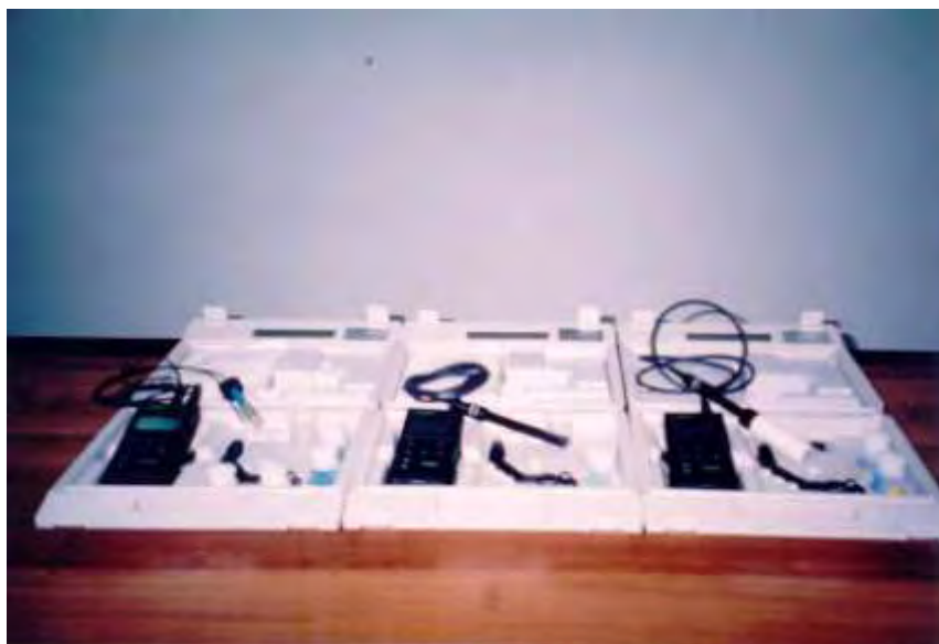
Εικόνα 7: Τα ηλεκτρονικά όργανα (Οξυγονόμετρο: WTW OXI-330 SET-2 , Αλατόμετρο-Αγωγιμόμετρο: WTW LF-330 , Πεχάμετρο: WTW 330 SET-2 ), με τα οποία έγινε η καταγραφή των αβιοτικών παραμέτρων (θερμοκρασία, οξυγόνο, αλατότητα, αγωγιμότητα και pH) στην υδάτινη στήλη
