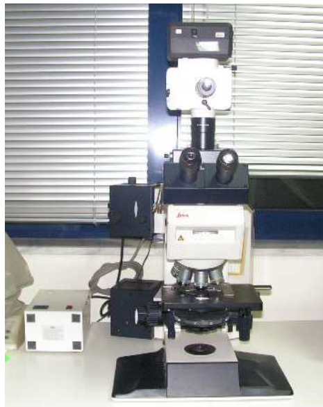
Εικόνα 14. Μικροσκόπιο αντίθετης φάσης (Leica DRMB), με σύστημα φωτογράφισης, για μέτρηση μορφολογικών χαρακτηριστικών.
