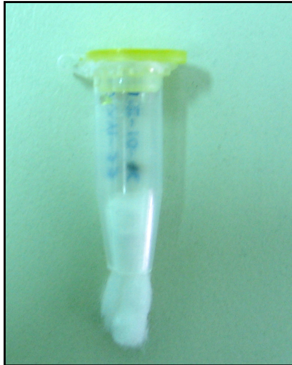
Εικόνα 6. Σωλήνας Eppendorf® κατάλληλα διαμορφωμένος σε μικροκλωβό διατροφής
