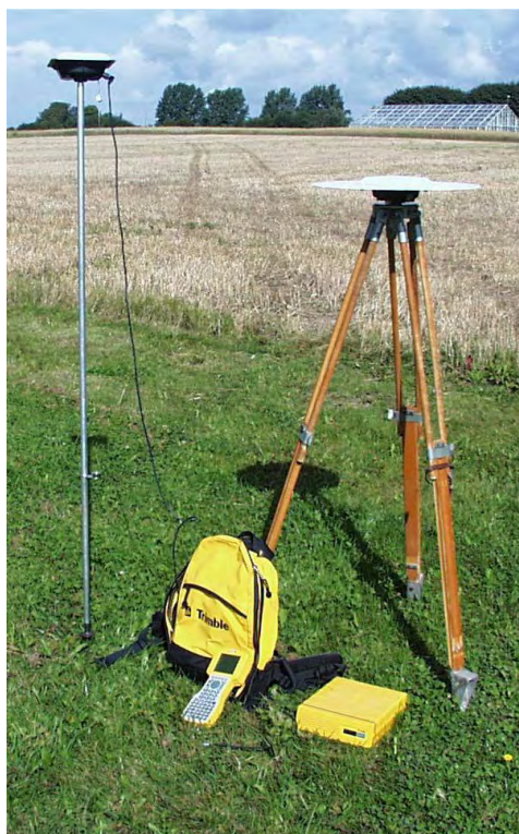
Εικόνα 2.2.3-3 Real Time Kinematic GPS
