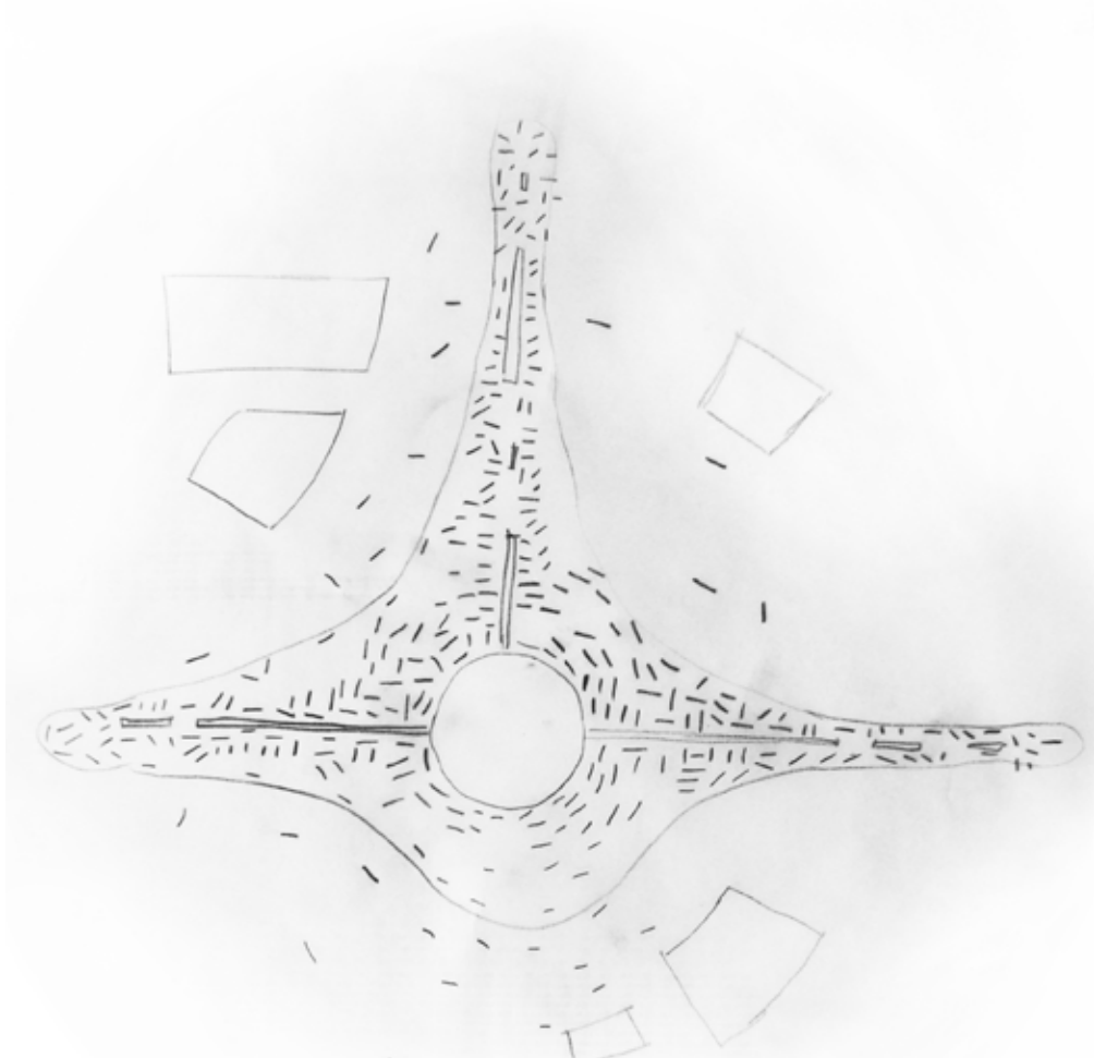
Μορφή οικισμού με κέντρο τον υδατόπυργο και τους άξονες διανομής νερού. Οι κατοικίες αναπτύσσονται με σχετικά ελεύθερη πύκνωση γύρω από τις υποδομές.
