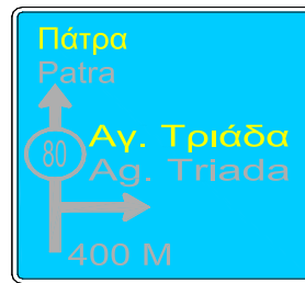
Σχήμα.2.2 : Πινακίδα Π-2 Προειδοποιητική κατευθύνσεων η οποία τοποθετείται στις οδούς ταχείας κυκλοφορίας προ διακλαδώσεων με αναγραφές κατευθύνσεων και χιλιομετρικών αποστάσεων
