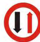
P-5 Προτεραιότητα της αντιθέτως ερχόμενης κυκλοφορίας λόγω στενότητας του οδοστρώματος.
