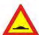
K-10 Επικίνδυνο υπερυψωμένο οδόστρωμα ή απότομη κυρτή αλλαγή της κατά μήκος κλίσης της οδού.
